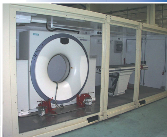
CT v přepravní poloze (odejmuta boční stěna)
