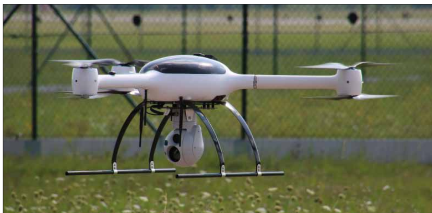
Bezpilotní prostředek BRUS s instalovanou novou elektro-optickou hlavicí
