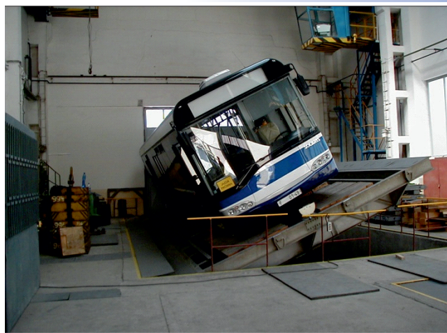
Zkouška statické příčné stability autobusu
