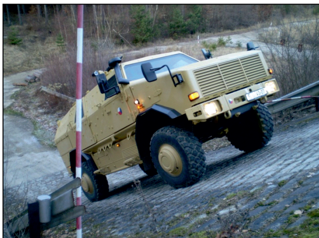
Ověřování parametru stoupavosti vozidla
