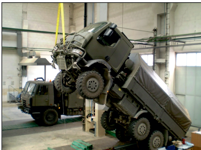
Měření polohy těžiště vozidla
