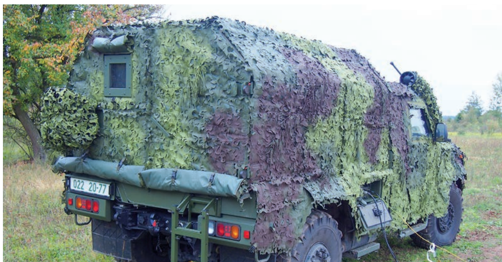
Do výbavy vozu Iveco LMV je zařazena mobilní maskovací souprava MM-BF-PODTEO/L ve variantě „lesní“. Jedná se o multispektrální kamufláž určenou k trvalému maskování techniky (za jízdy i při stání) proti prostředkům pozemního i vzdušného průzkumu ve viditelné, infračervené (blízké, střední, vzdálené) a mikrovlnné oblasti spektra. Maskovací dílce se na vozidlo upevňují bez zásahu do konstrukce vozidla pomocí samolepicích suchých zipů Velcro Ultramat.
